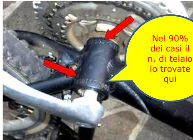
l'occultamento tramite diverse mani di vernice e la sua asportazione, tramite abrasione, mette in pericolo la resistenza del telaio stesso, oltreché essere un'attività lunga e laboriosa.
